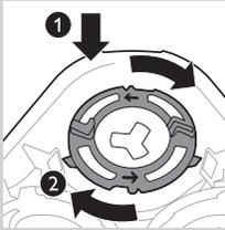
**8** Do držáku holicí hlavy umístěte zpět zajišťovací kroužky a otočte jimi ve směru hodinových ručiček.
