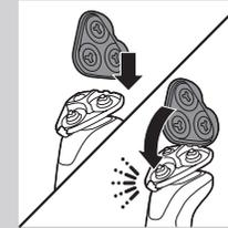
**9** Znovu vložte závěs držáku holicí hlavy do zářezu holicí jednotky. Uzavřete držák holicí hlavy (ozve se cvaknutí).
