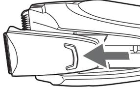
**2** Posuňte přesný zastříhávač až do jeho maximální výšky.
